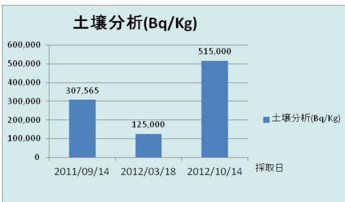
図 7 渡利薬師町水路底の土壌汚染
