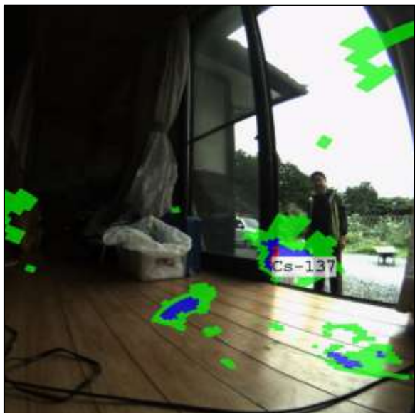
写真3 H氏宅廊下のガンマ線イメージング
